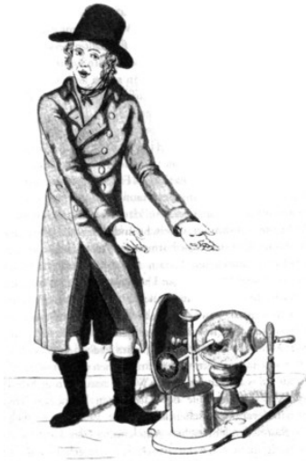
VII. kép. Dörzsöléssel működő elektromosságot gerjesztő gép – selyempárnán forgatott üveg-gömb
